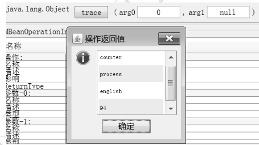
图 3.17 jconsole 中进行 trace 观测实例接口调用
